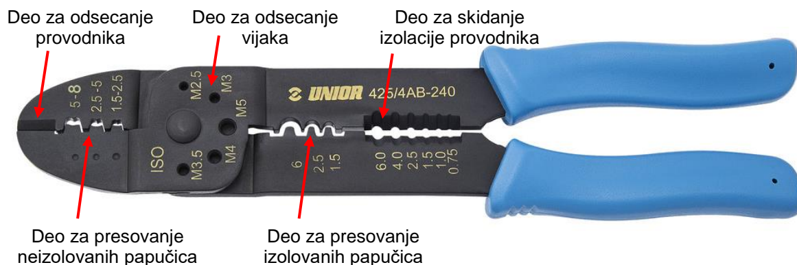
Slika 6.14 Klešta za odsecanje provodnika, skidanje izolacije provodnika i krimpovanje kablovskih papučica
