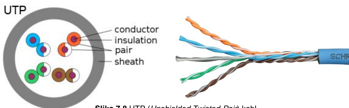
Slika 7.8 UTP ( Unshielded Twisted-Pair ) kabl
