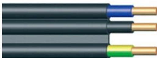
Slika 4.11 Provodnik PP/R – Y 3x1,5 mm 2 300/500V
