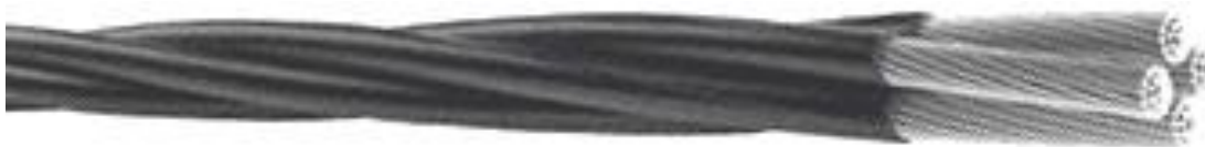
Slika 5.4 Samonosivi kablovski snop X00–A 4x16mm 2 0,6/1kV
