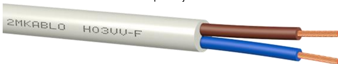
Slika 4.7 Provodnik PP/L 2x0,5 (oznaka po DIN standardu je H03VV-F 2G 0.5mm 2 380V)
