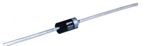
Sl.2.29 Ispravljačka dioda (kućište DO-41)
