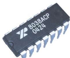
Sl.2.48 Integrirano kolo sa kućištem DIL-14
