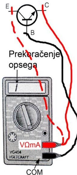
Sl.3.16 Merenja pri inverznoj polarizaciji
