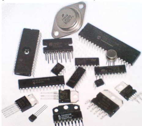
Sl.2.47 Izgled integrisanih kola sa različitim kućištima
