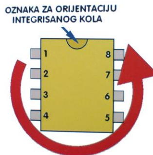
Sl.2.51 Orijentacija integriranog kola
