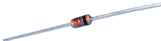
Sl.2.31 Univerzalna dioda (kućište DO-35)
